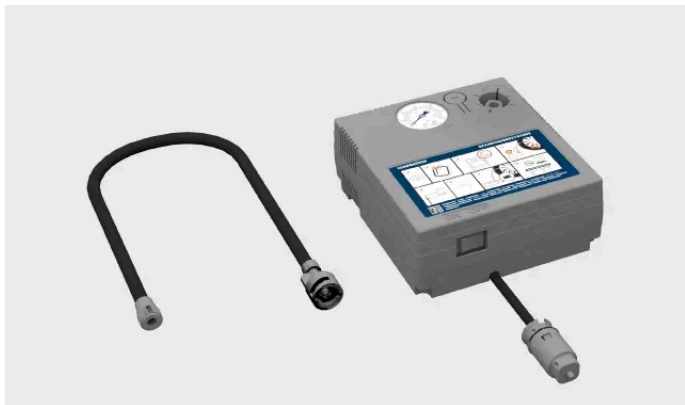
Översikt över den tillfälliga däcktätningssatsens kompressor
