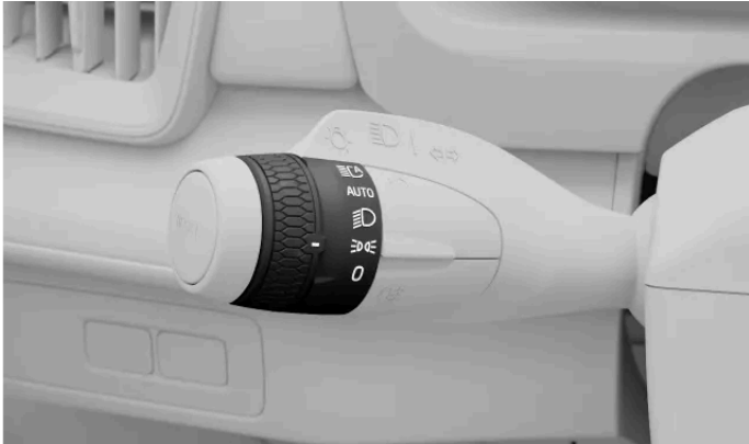
Positionsljussymbolen på vridringen på vänster rattspak
