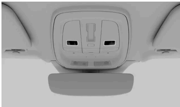
De främre läslamporna på takkonsolen
