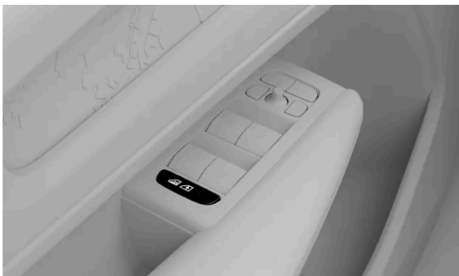
Placering av knapppanelen för barnlåset i dörrpanelen
