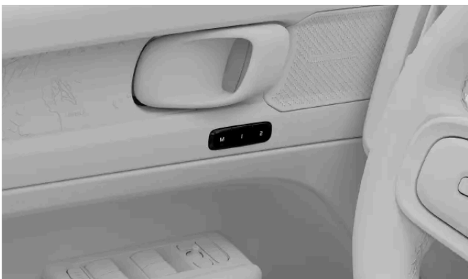
Placering av knapparna för förinställningar av sätesjustering
