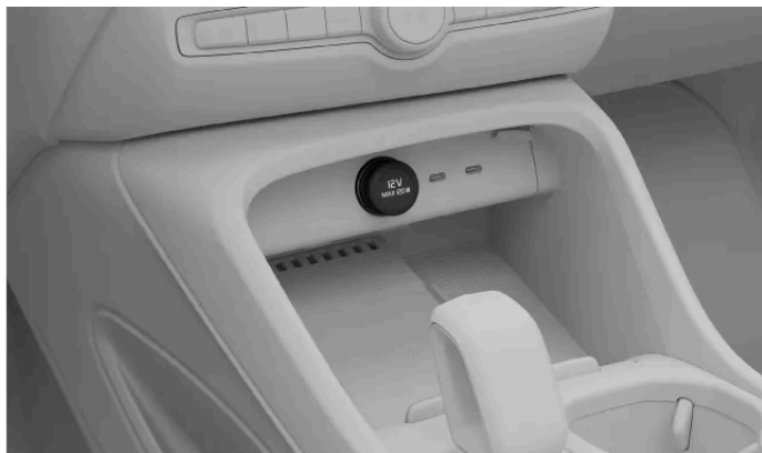
12 V-eluttaget i tunnelkonsolen
