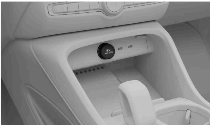
12 V-eluttaget i tunnelkonsolen
