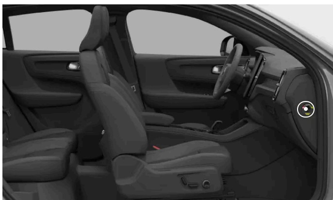
Placering av passagerarkrockkuddens omkopplare
