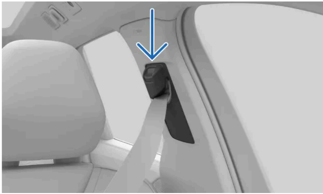
Säkerhetsbältets övre förankringspunkt
