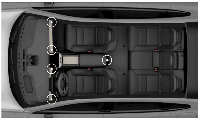
De reglerbara ventilationsmunstyckenas placering
