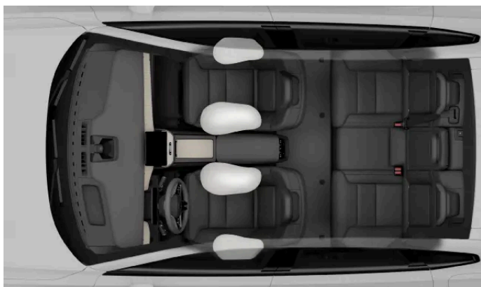
Samtliga sidokrockkuddar för främre passagerare.
