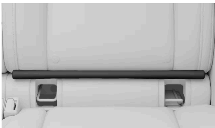
Den vikta ISOFIX-fliken, instoppad i springan ovanför förankringspunkterna
