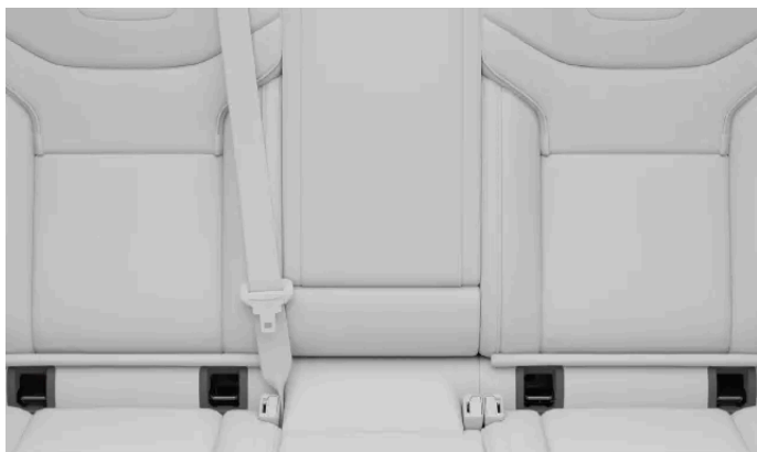
Placeringar av ISOFIX-förankringspunkter för baksätena
