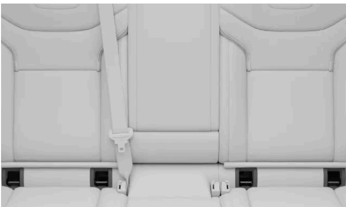
Placeringar av ISOFIX-förankringspunkter för baksätena
