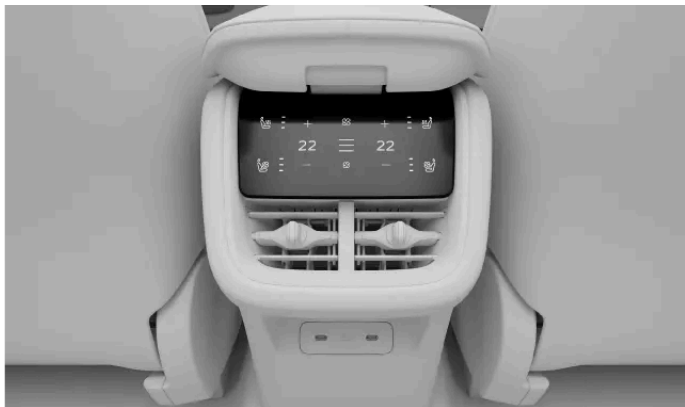
Klimatreglage på tunnelkonsolen
