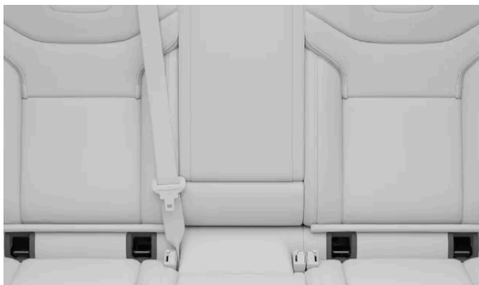
Placeringar av ISOFIX-förankringspunkter för baksätena
