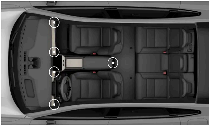
De reglerbara ventilationsmunstyckenas placering
