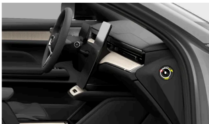
Placering av passagerarkrockkuddens omkopplare
