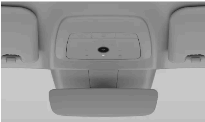
Avfrostningsknapp i takkonsolen
