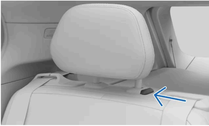
Låsknapp på nackstödet
