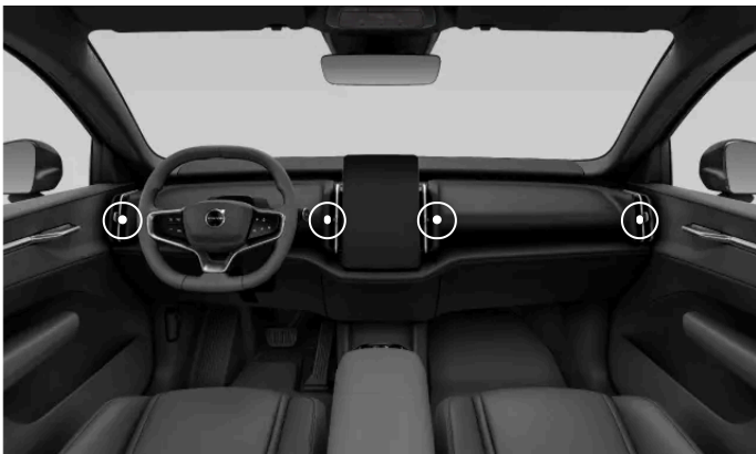
De reglerbara ventilationsmunstyckenas placering.
