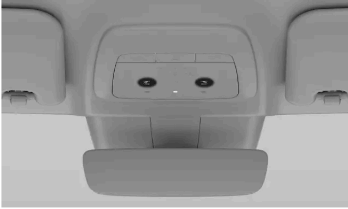
Framsätens läslampor i takkonsolen
