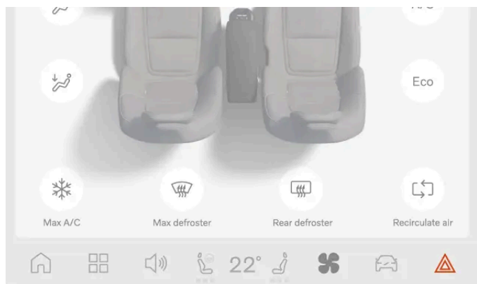
Knappen för varningsblinkers sitter på displayen
