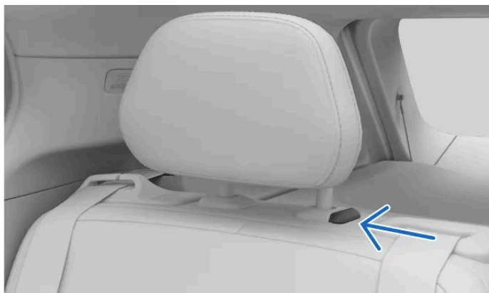
Låsknapp på nackstödet
