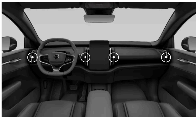
De reglerbara ventilationsmunstyckenas placering.
