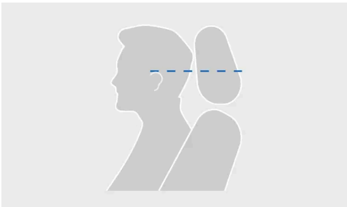
Korrekt nivå på nackstödet
