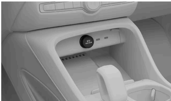
12 V-eluttaget i tunnelkonsolen
