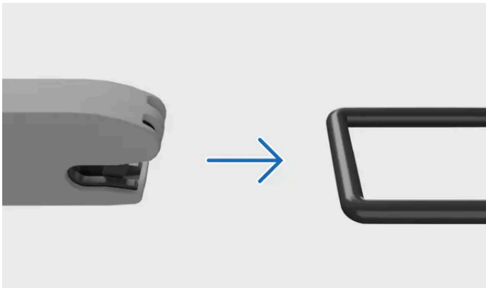
Fästa till ISOFIX förankringspunkt
