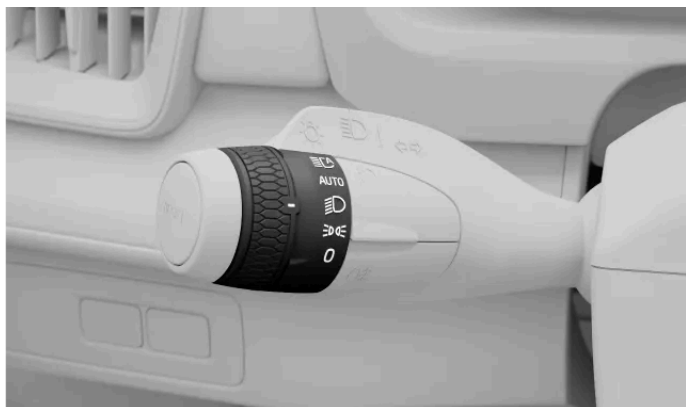
Halvljussymbolen på vridringen på vänster rattspak
