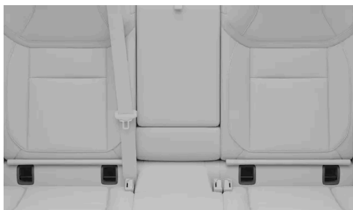
Placeringar av ISOFIX-förankringspunkter för baksätet
