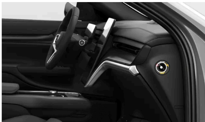
Placering av passagerarkrockkuddens omkopplare
