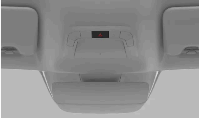
Placeringen av knappen för varningsblikkers i takkonsolen
