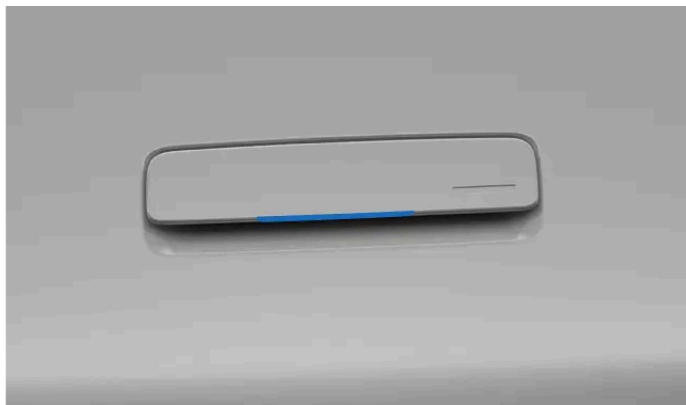
Beröringspunkt på undersidan av dörrhandtaget.
