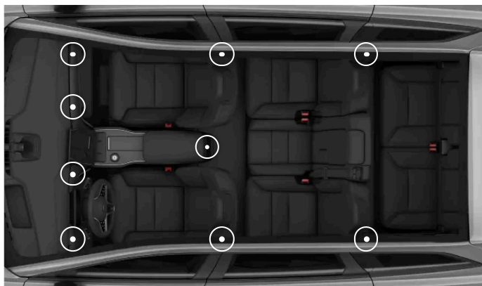
De reglerbara ventilationsmunstyckenas placering
