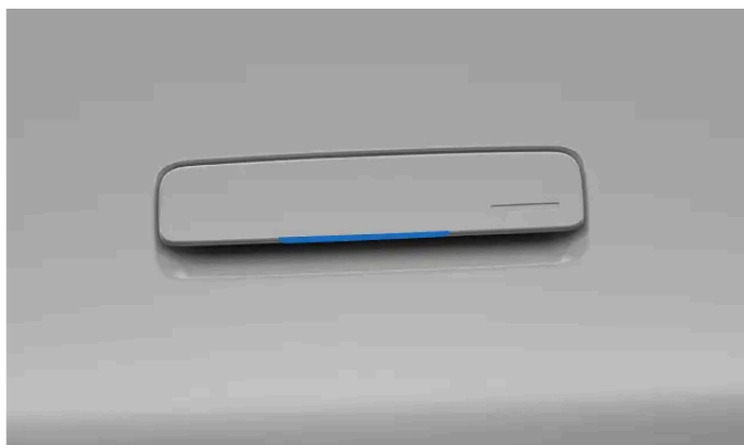
Beröringspunkt på undersidan av dörrhandtaget.
