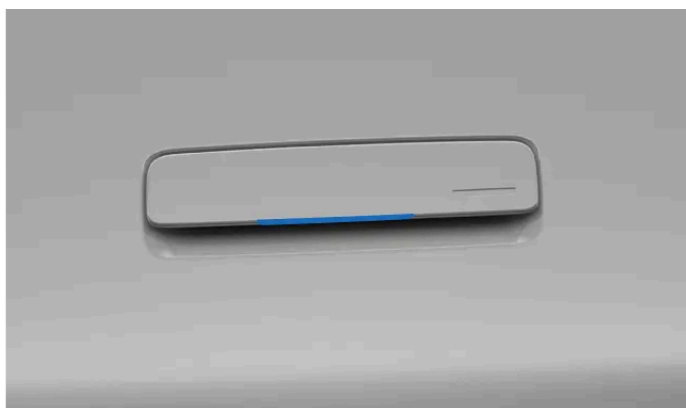
Beröringspunkt på undersidan av dörrhandtaget.
