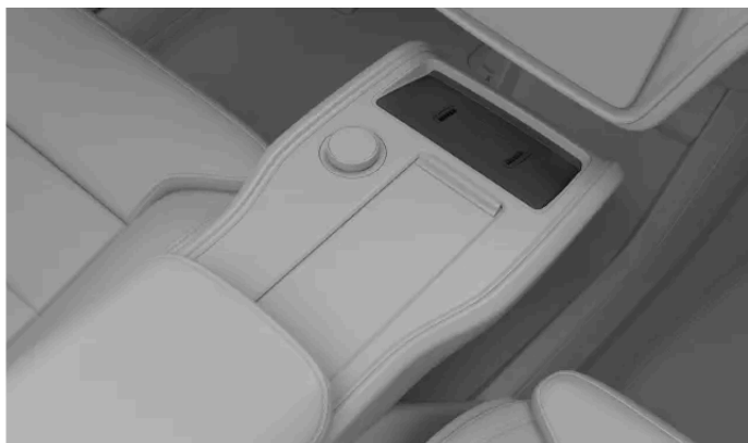
Nyckelläsaren mellan framsätena är också en trådlös laddare.
