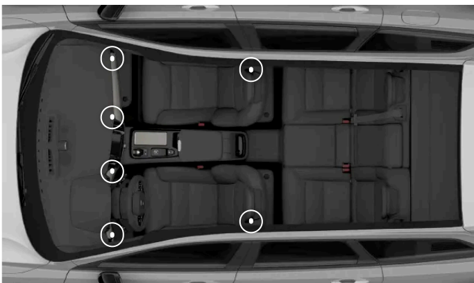
De reglerbara ventilationsmunstyckenas placering
