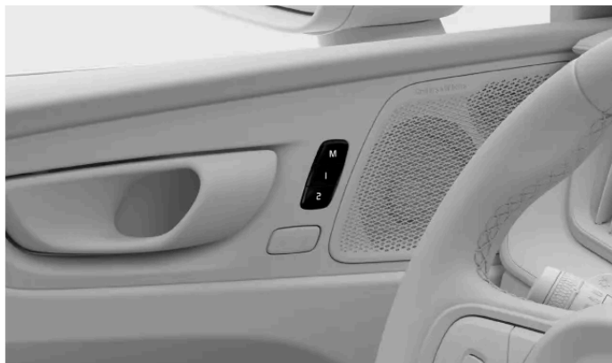
Placering av knapparna för förinställningar av sätesjustering
