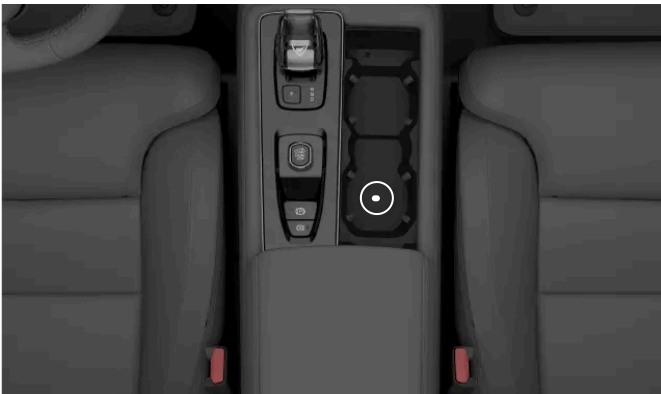
Reservläsarens placering i mugghållaren i tunnelkonsolen
