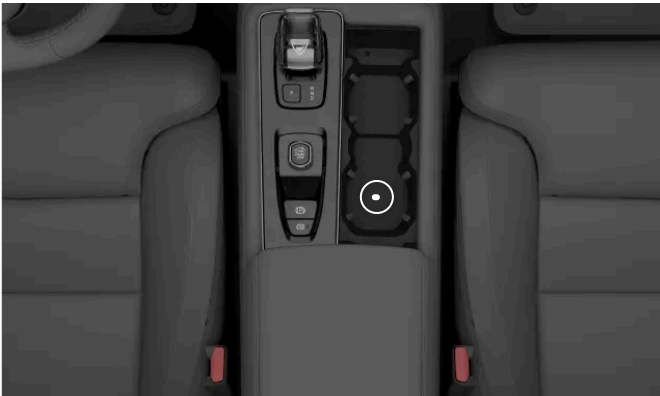
Placering av backup-läsaren i mugghållaren i tunnelkonsolen
