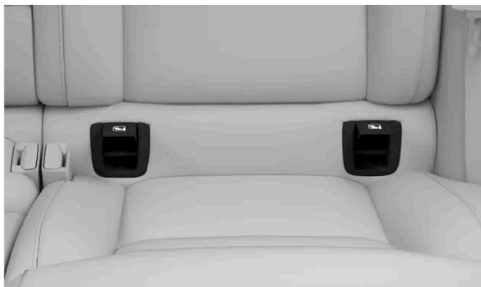
Placeringar av ISOFIX-förankringspunkter för de yttre baksätena.
