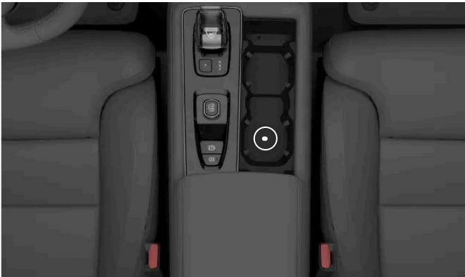
Placering av backup-läsaren i mugghållaren i tunnelkonsolen
