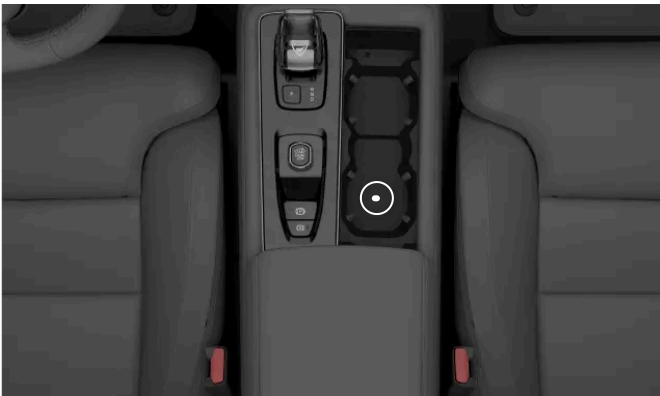
Reservläsarens placering i mugghållaren i tunnelkonsolen
