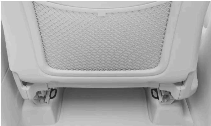
Nedre förankringspunkter sitter på golvskenorna för framsätet.
