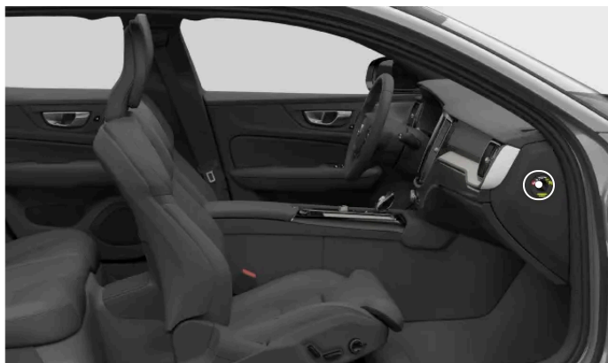
Placering av passagerarkrockkuddens omkopplare
