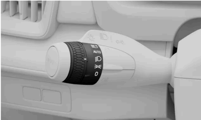
Halvljussymbolen på vridringen på vänster rattspak
