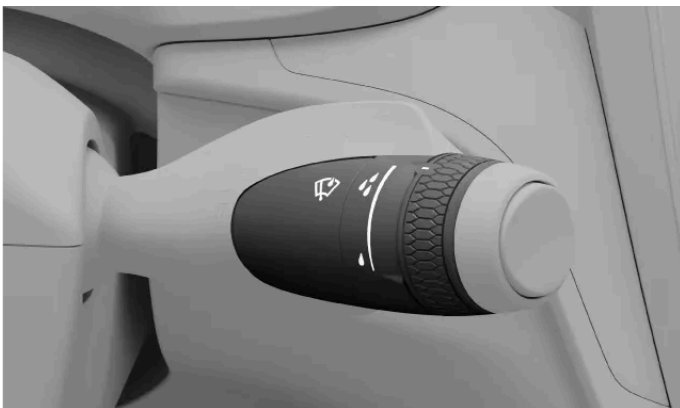
Reglagen för de främre torkarna sitter på höger rattspak.
