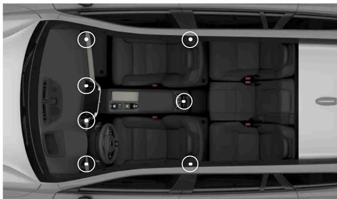
De reglerbara ventilationsmunstyckenas placering
