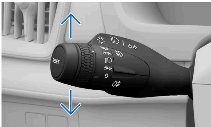
Blinkers på den vänstra rattspaken
