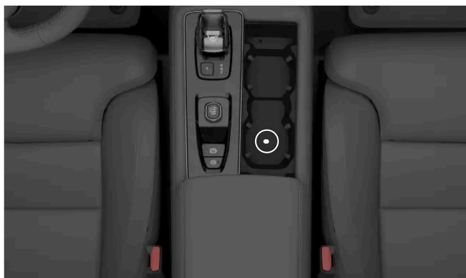
Reservläsarens placering i mugghållaren i tunnelkonsolen
