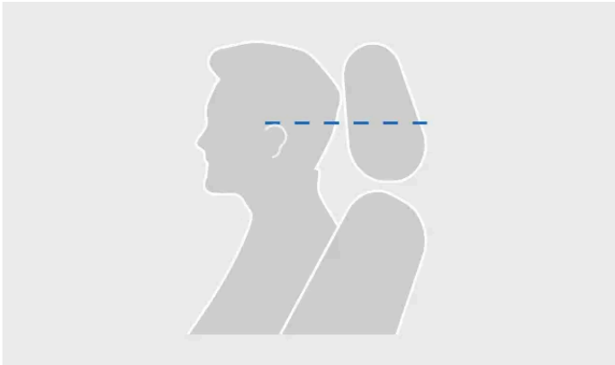
Korrekt nivå på nackstödet
