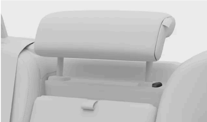
Låsknapp på nackstödet
