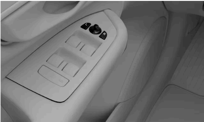
Reglage för justering av sidospeglarna
