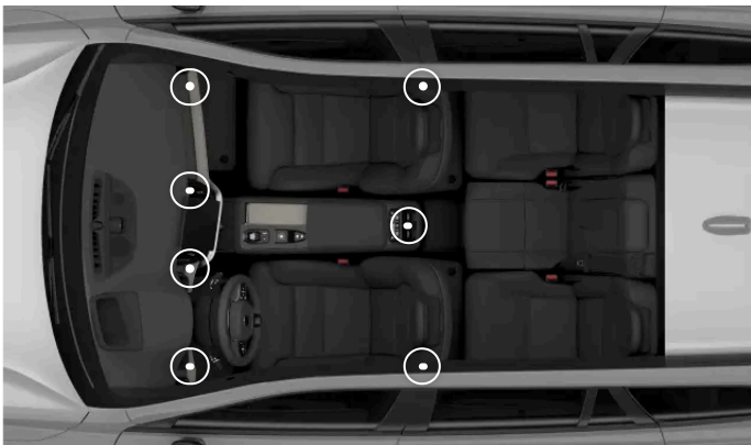
De reglerbara ventilationsmunstyckenas placering
