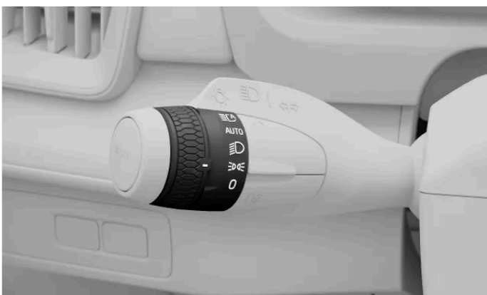
Positionslyssymbolen på vridningen på vänster rattspak
