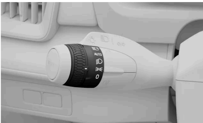
Positionslyssymbolen på vridningen på vänster rattspak
