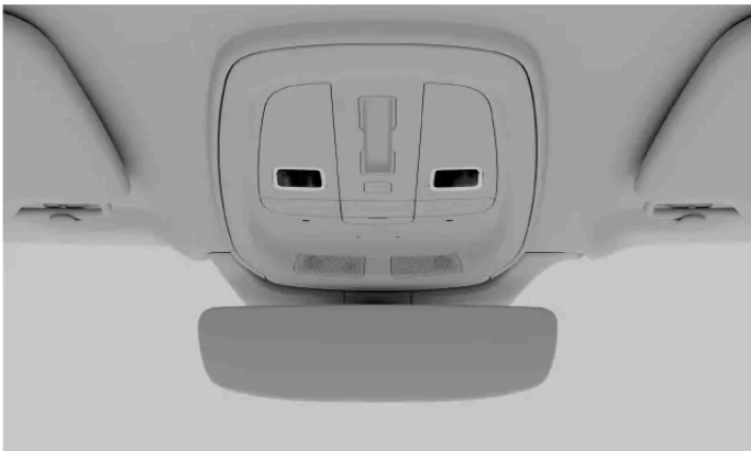
De främre läslamporna på takkonsolen
