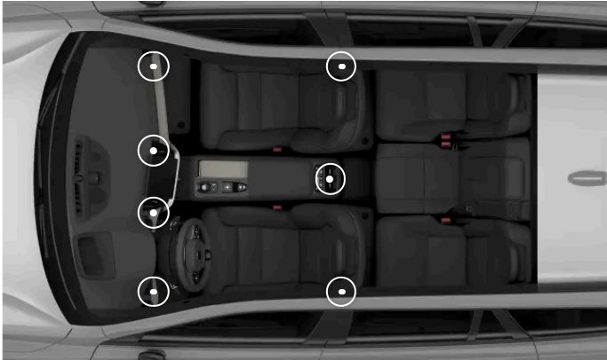
De reglerbara ventilationsmunstyckenas placering
