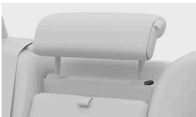
Låsknapp på nackstödet
