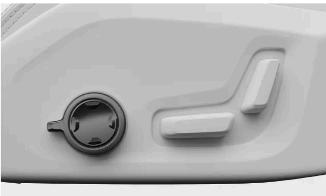
Sätesjusteringsratten sitter på den sida av sätet som är närmast dörren.
