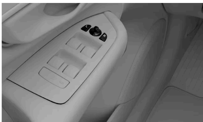
Reglage för justering av sidospeglarna
