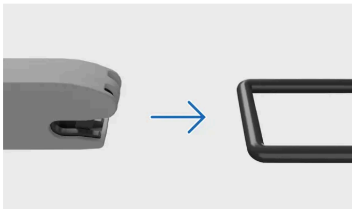
Fästa till ISOFIX förankringspunkt
