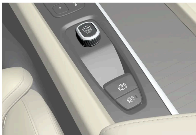
Startvredet i tunnelkonsolen.
