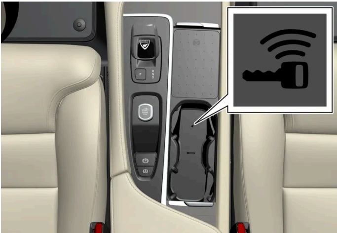
Backup-läsarens placering i tunnelkonsolen.
