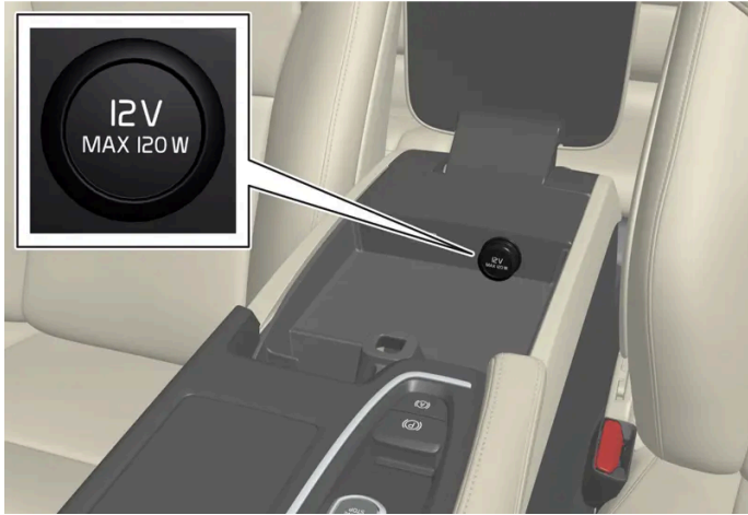
12 V-eluttag i tunnelkonsol, framsäte.
