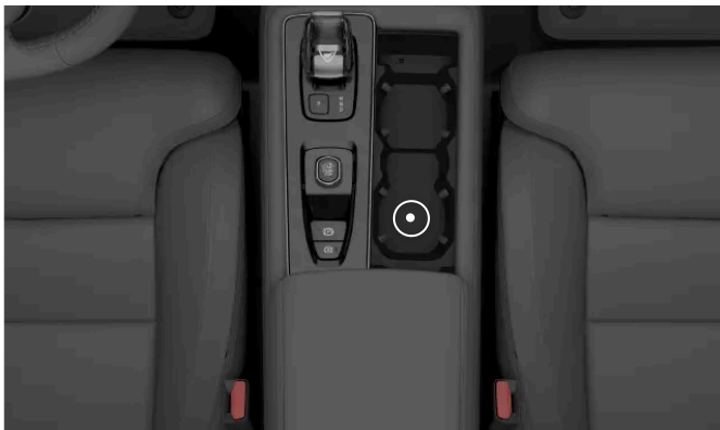
Placering av backup-läsaren i mugghållaren i tunnelkonsolen
