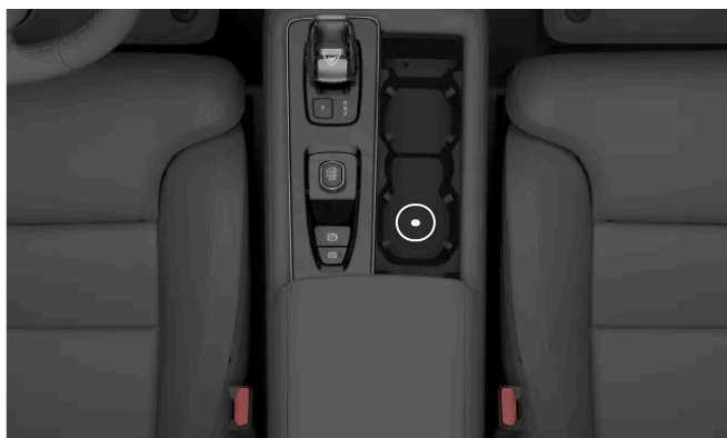
Placering av backup-läsaren i mugghållaren i tunnelkonsolen
