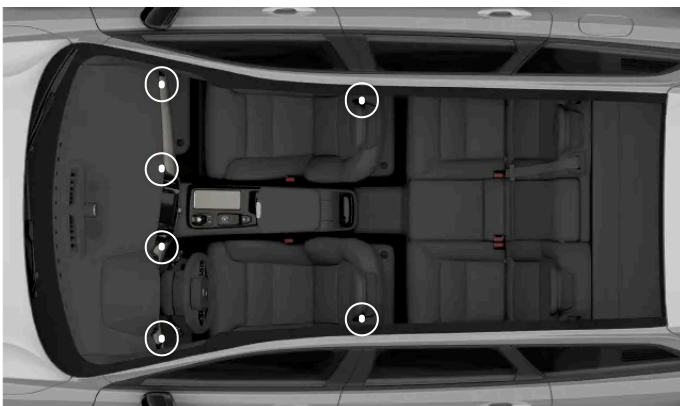
De reglerbara ventilationsmunstyckenas placering
