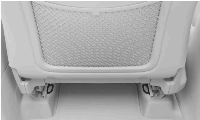
Nedre förankringspunkter sitter på golvskenorna för framsätet.
