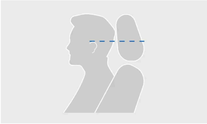
Korrekt nivå på nackstödet
