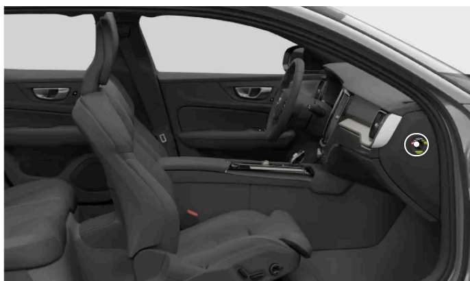
Placering av passagerarkrockkuddens omkopplare
