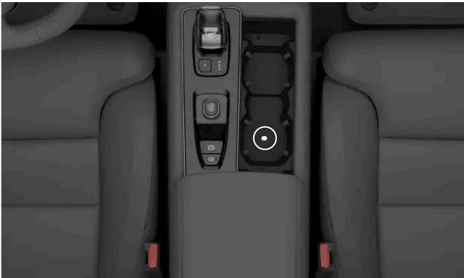
Placering av backup-läsaren i mugghållaren i tunnelkonsolen
