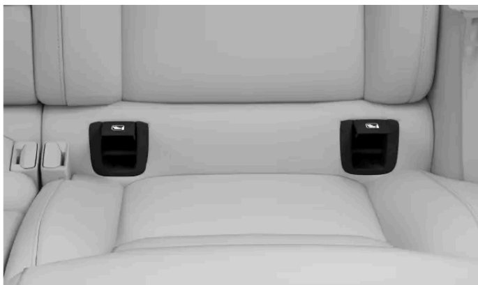
Placeringar av ISOFIX-förankringspunkter för de yttre baksätena.
