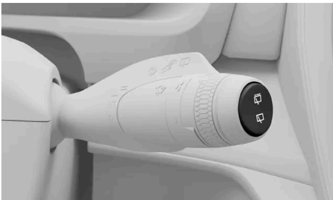
Bakrutetorkarens reglage sitter på höger rattspak.
