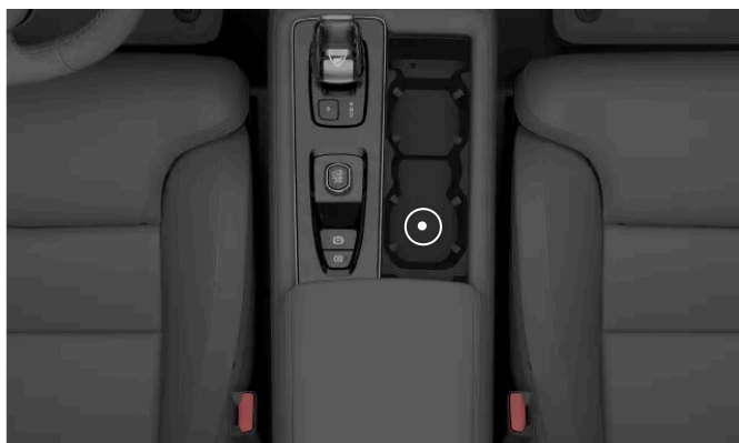
Placering av backup-läsaren i mugghållaren i tunnelkonsolen
