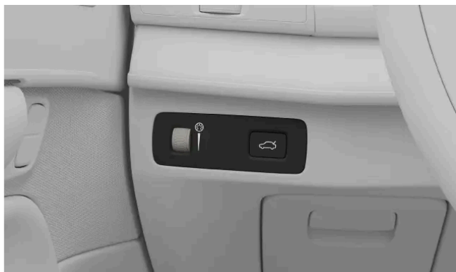
Tumhjul för justering av innerbelysningen
