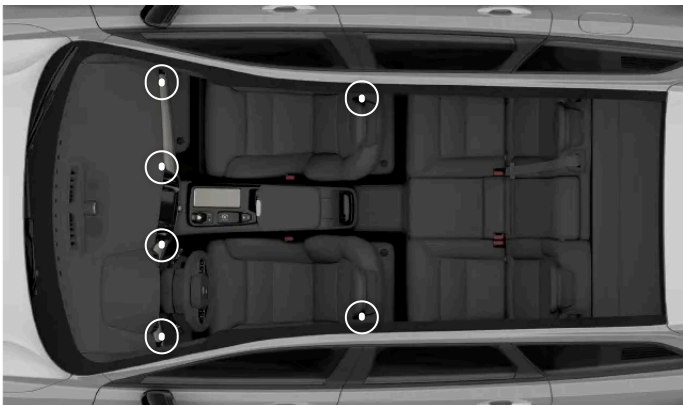
De reglerbara ventilationsmunstyckenas placering
