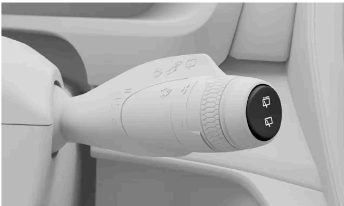
Bakrutetorkarens reglage sitter på höger rattspak.
