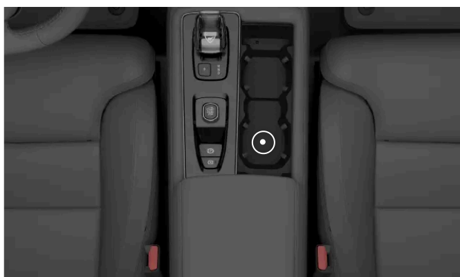
Placering av backup-läsaren i mugghållaren i tunnelkonsolen
