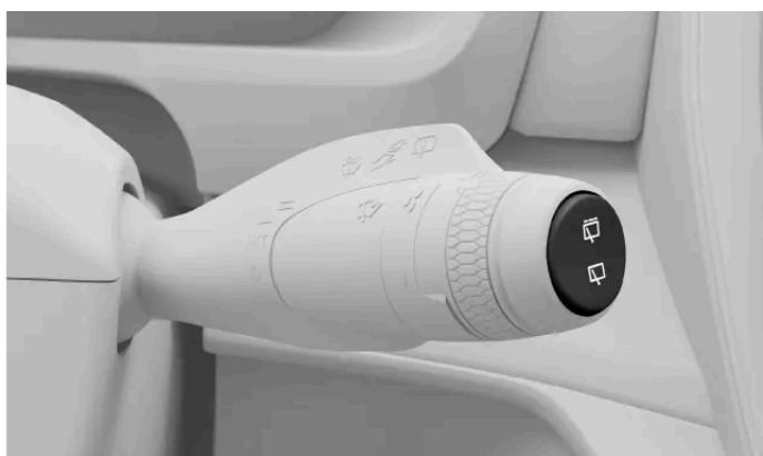
Bakrutetorkarens reglage sitter på höger rattspak.
