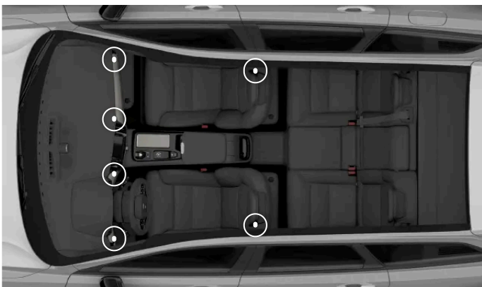
De reglerbara ventilationsmunstyckenas placering
