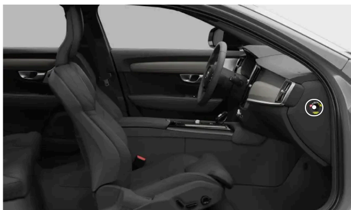
Placering av passagerarkrockkuddens omkopplare
