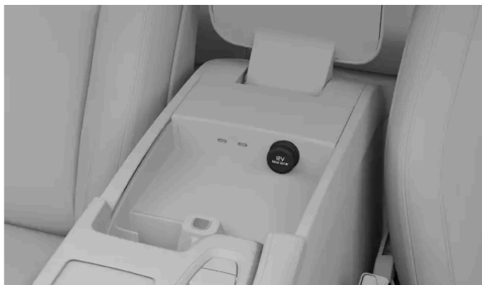
12 V-uttaget i tunnelkonsolen
