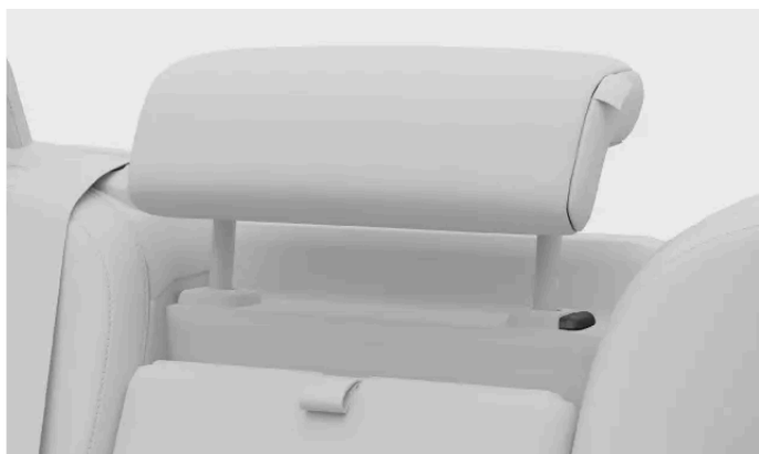
Låsknapp på nackstödet
