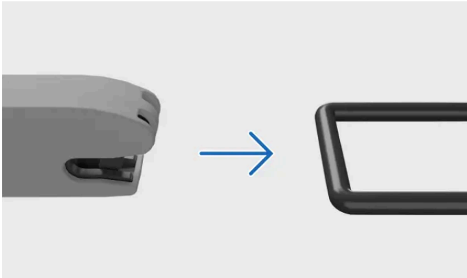
Fästa till ISOFIX förankringspunkt
